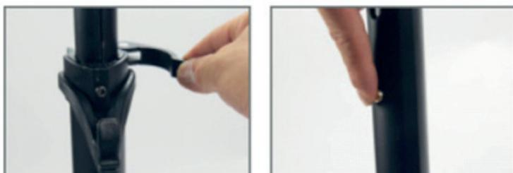
Откройте механизм натяжения на рулевой колонке, поднимите телескопическую стойку до необходимой высоты и направьте ее в соответствующие отверстия до щелчка.
