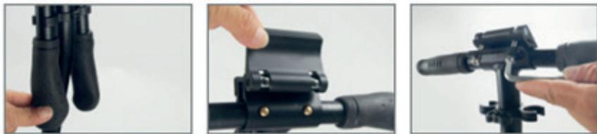
Вытяните рукоятки из креплений, затем поместите их в специальные отверстия на руле и зафиксируйте кнопками.
