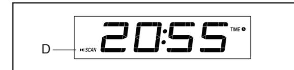
Чтобы вручную пройти цикл сканирования, нажмите кнопку Scan несколько раз.
