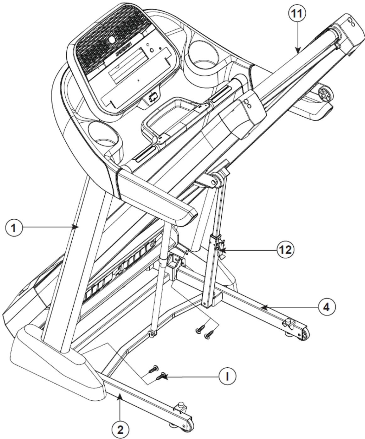
Поднимите деку (11) до полной фиксации ножной защелки (12).
