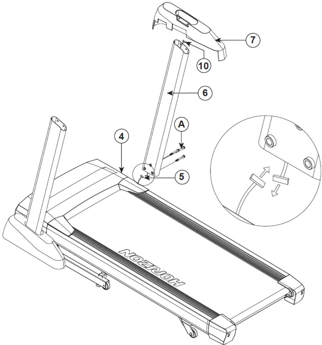
Протяните кабель консоли рамы (5) через основную раму.
